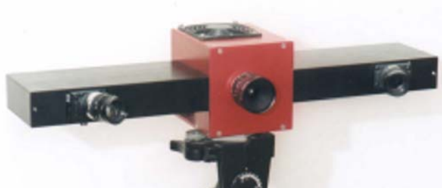
Slika 19. Projekcijski mjerni senzor "Atos"
