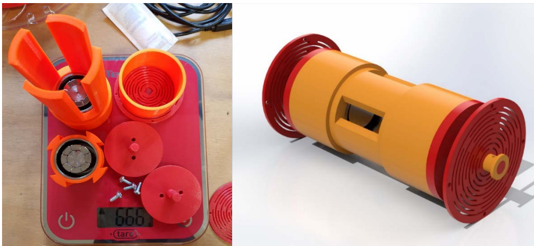
Slika 4.1 Masa pomičnih dijelova (lijevo) i CAD prikaz pomičnih dijelova
