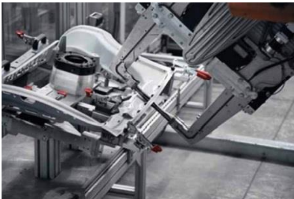
Slika 8 Elektrootporno točkasto zavarivanje aluminijskog okvira vrata automobila [12]
