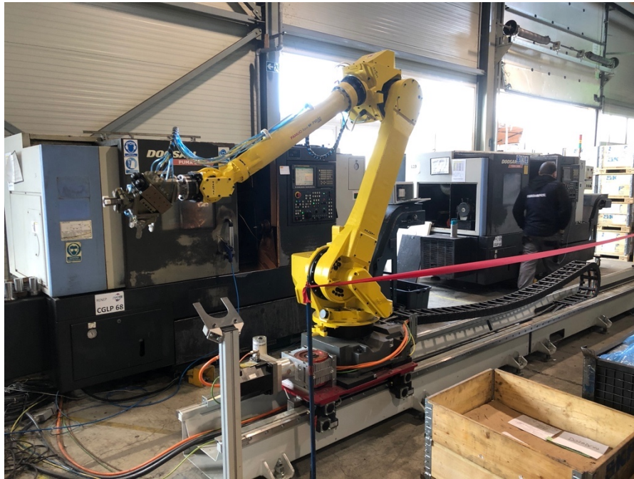
Slika 35. Prikaz robotske ruke s CNC strojevima i pokretnom trakom
