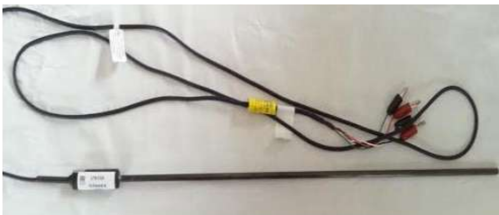
Slika 7. Platinski otpornički termometri
