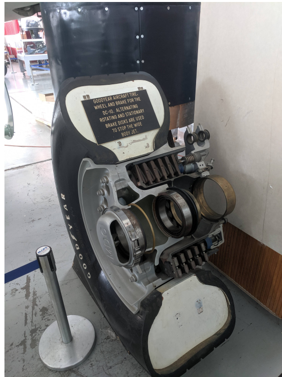
Slika 1.1: Poprečni presjek zrakoplovnog naplatka [2]
