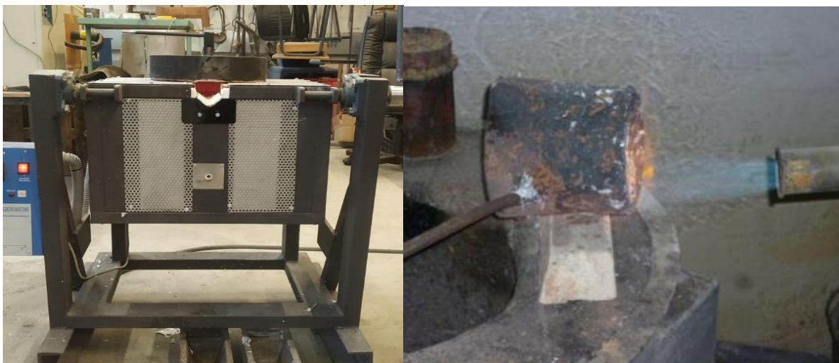
Slika 42. Elektrootporna peć i zagrijavanje ljevačkog lonca
