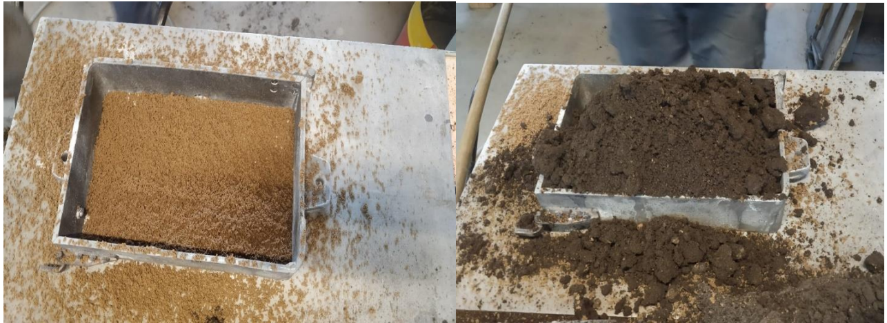
Slika 35. Dodavanje modelne i punidbene kalupne mješavine
