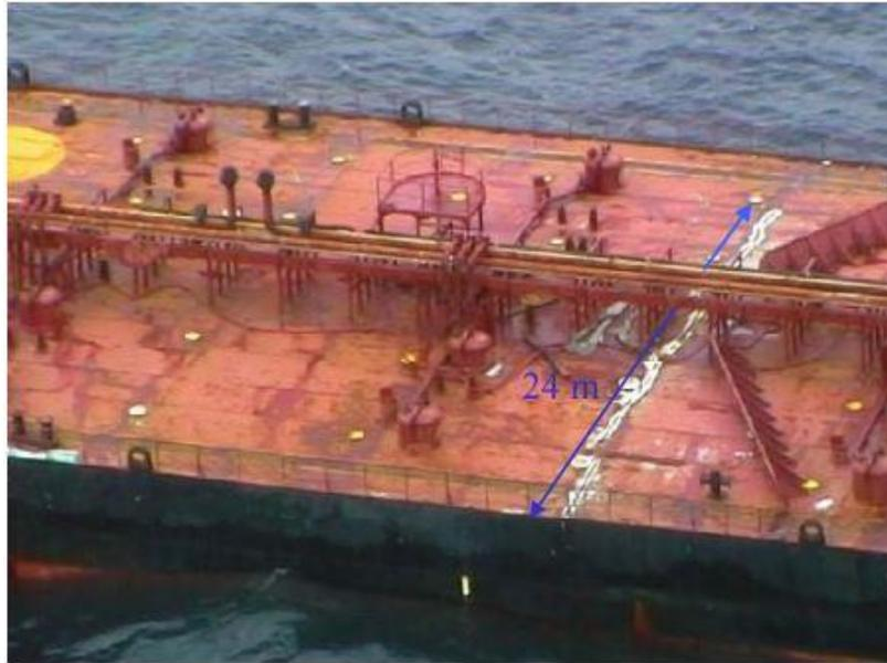
Slika 4.4 Pukotina preko palube tankera Castor[118]
