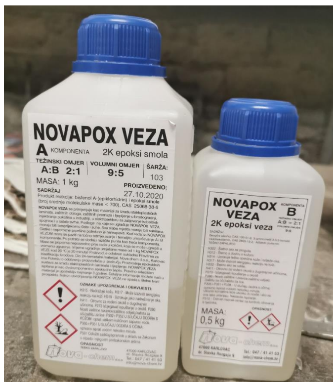
Slika 13. Dvokomponentna smjesa NOVAPOX VEZA korištena za izradu materijala matrice; komponenta A – epoksi smola, komponenta B – epoksi veza.
