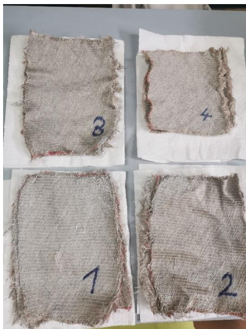
Slika 12. Lanena vlakna nakon alkalne obrade i sušenja u peći.
