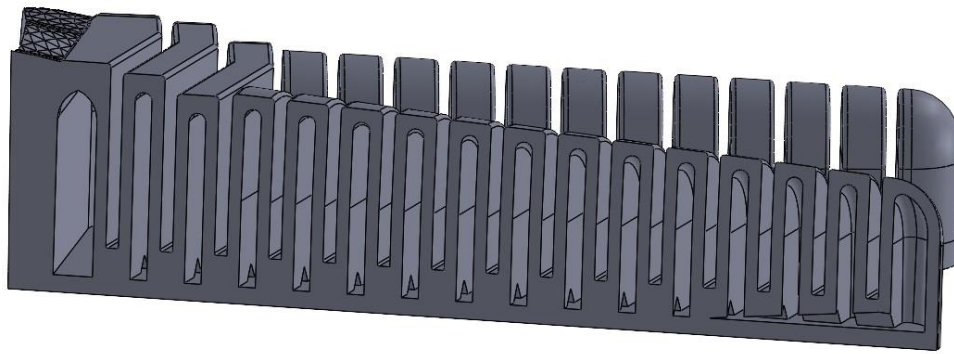
Slika 75. Poprečni presjek Srednjaka iz seta prstiju 1-2
