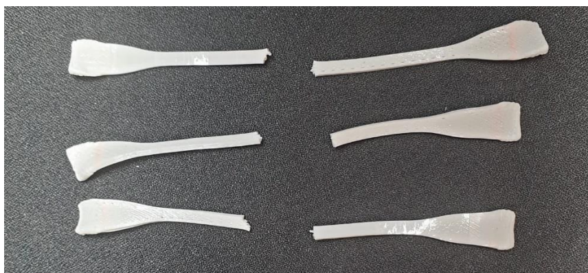
Slika 12. Uzorci uspješnog vlačnog ispitivanja materijala
