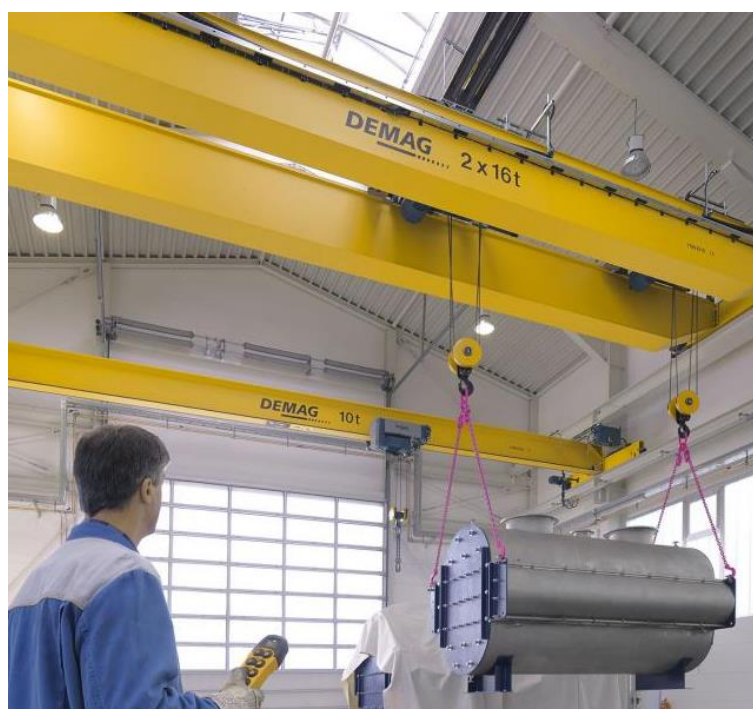
Slika 7. Glavni nosači izrađeni od limova[6]
