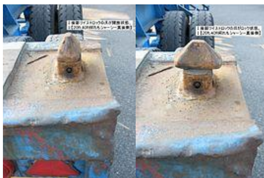
Slika 3. Twistlock otključani ili otvoreni položaj (lijevo) i zatvoreni ili zaključani položaj (desno)
