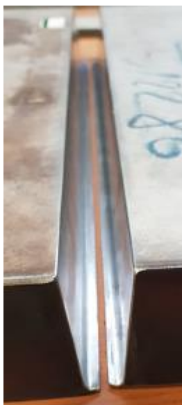
Slika 12. U-priprema radnog komada
