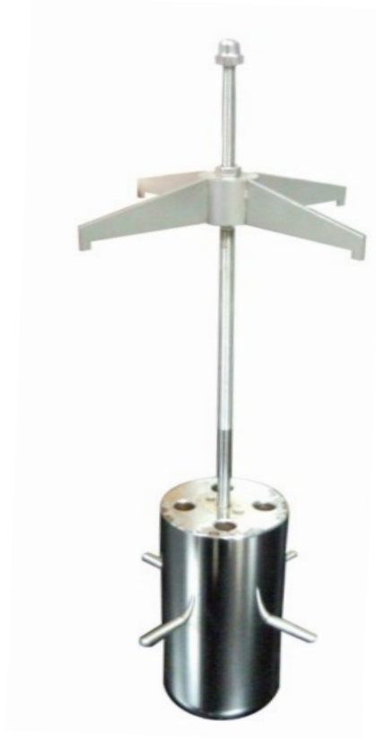
Slika 2. Primjer izotermalnog bloka termostatiranih kupki
