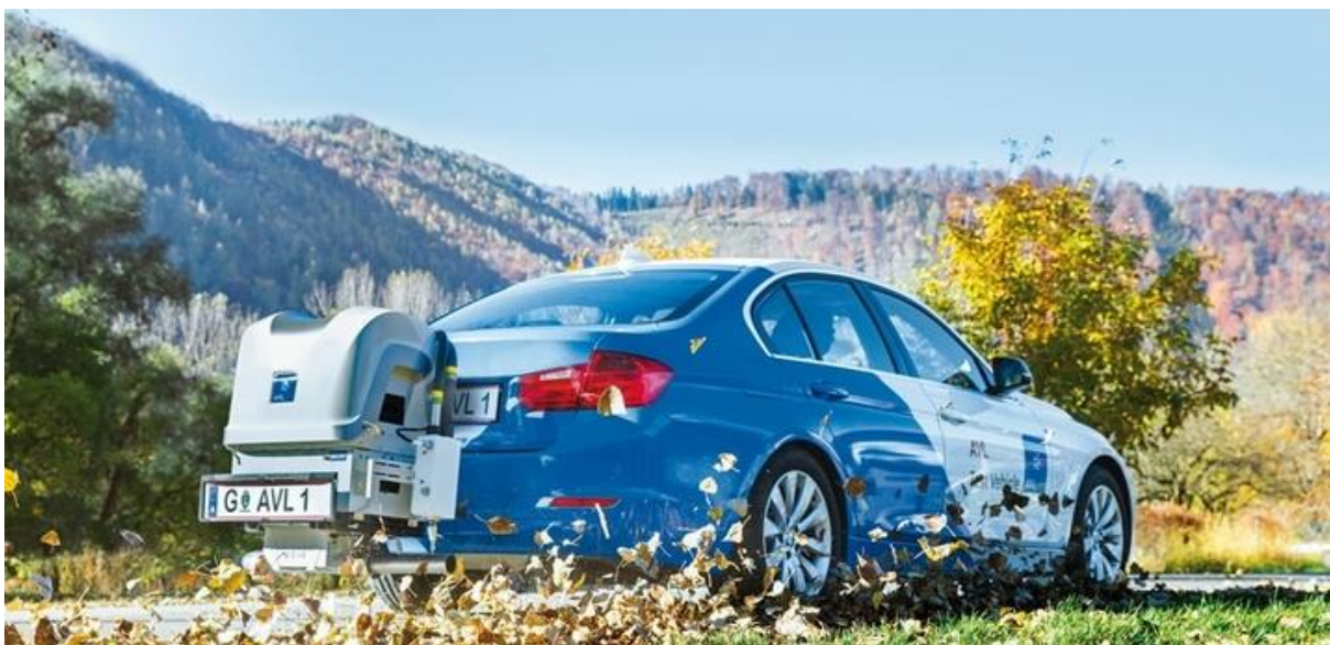
Slika 11. PEMS uređaj tvrtke AVL ugrađen na vozilo [6]
