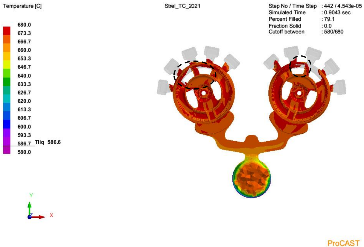
Slika 38. Prikaz punjenja kalupa pri 79,1% ispunjenosti 2.
