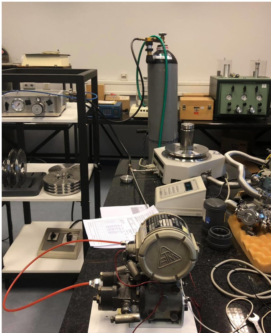
Slika 18. Umjeravanje tlačnom vagom TLVAG 09
