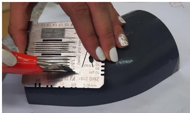
Slika 25. Urezivanje mrežice za ispitivanje prionjivosti
