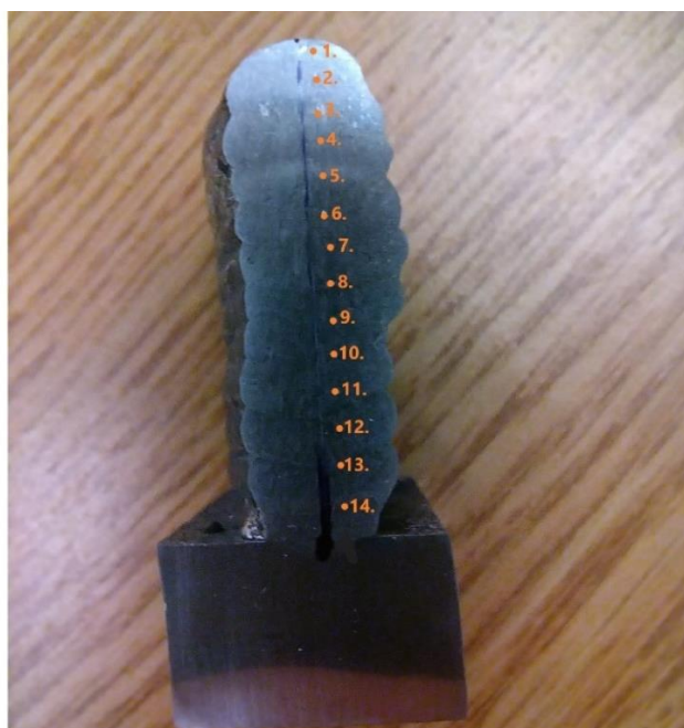
Slika 48. Točke mjerenja tvdoće na uzorku A
