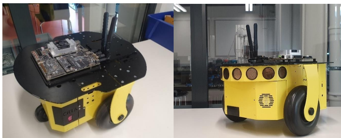
Slika 67. Mobilni robot s upravljačkim računalom NVIDIA Jetson TX2
