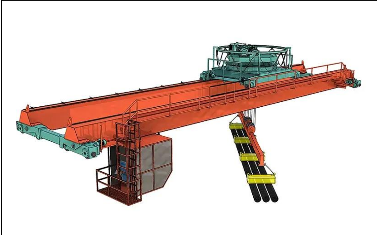
Slika 5. Mosni granik s vozičom vitla i rotacijom tereta tvrtke Arnikon [7]
