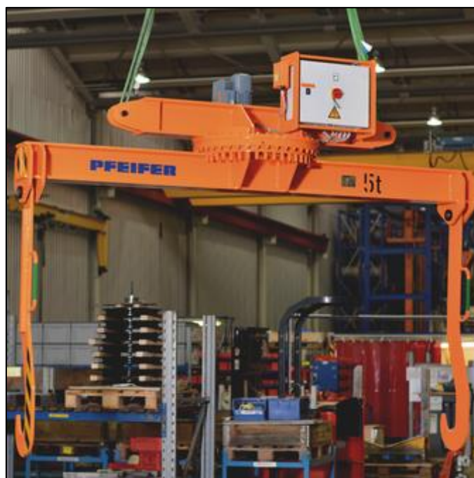
Slika 4. Rotirajući sustav pomoću zakretnog ležaja tvrtke Pfeifer [6]
