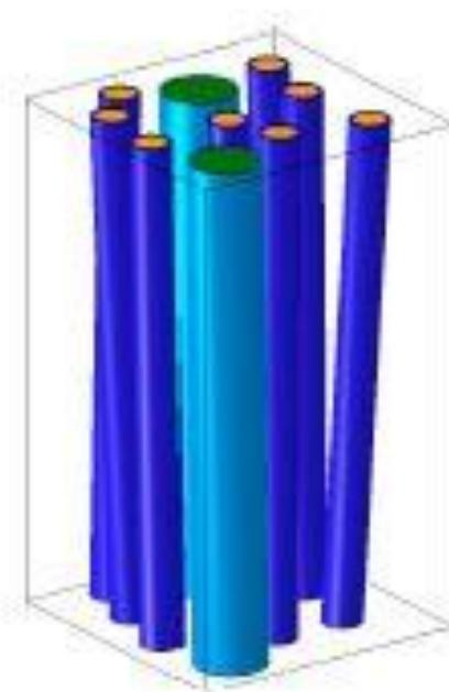
**Slika 29. Hibridni kompozit ojačan staklenim i ugljičnim vlaknima [25]**
