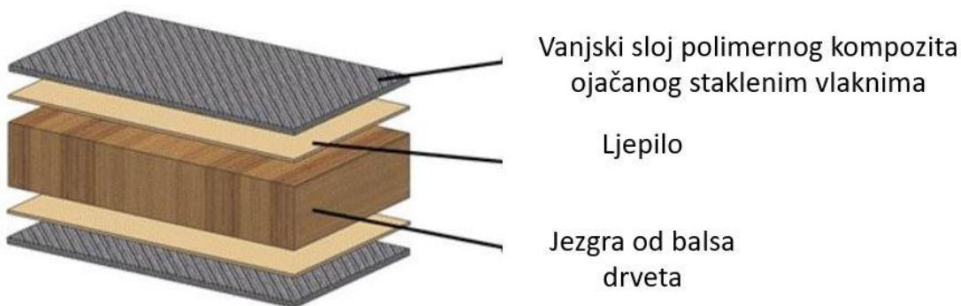
**Slika 32.** Sendvič – kompozit; polimerni kompozit ojačan staklenim vlaknima – drvo balsa [45]
