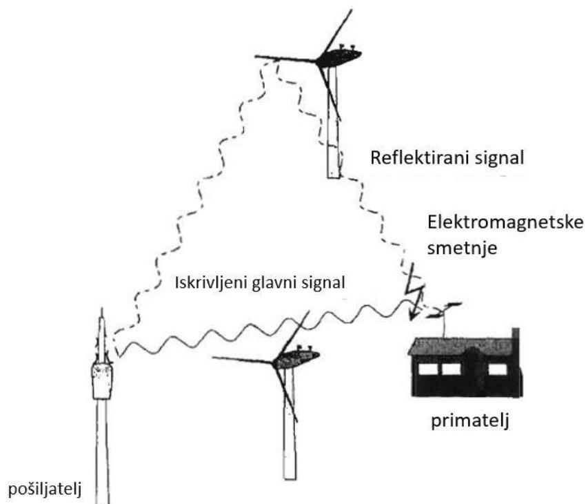
Slika 16. Raspršivanje elektromagnetskog signala zbog vjetroturbine [13]
