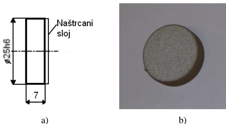
Slika 4.15 Dimenzije (a) i izgled (b) epruvete tipa B za ispitivanje prionljivosti
