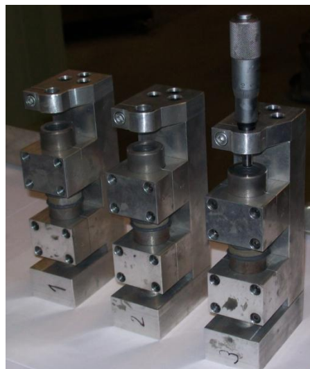
Slika 4.17 Zaljepljene epruvete u fazi sušenja
