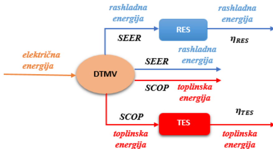
Slika 16. Prikaz energetskih tokova u sustavu DTMV s TES i RES
