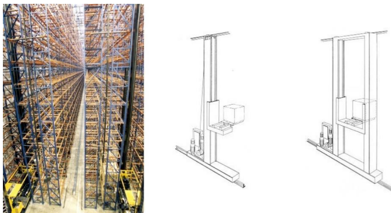
Slika 11. "Unit-load" AS/RS skladište (lijevo) i izvedbe automatiziranih dizalica (desno)
