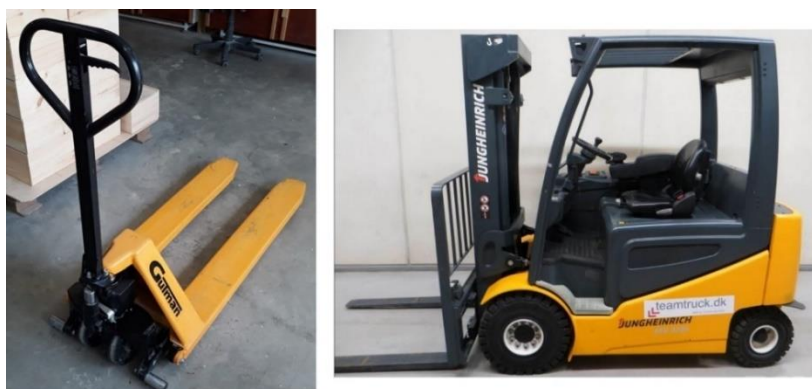
Slika 35. Ručni viličar (lijevo) i električni čeonu viličar (desno)
