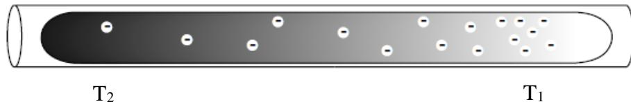
**Slika 5. Princip rada termoparova - Seebeckov efekt [3]**
