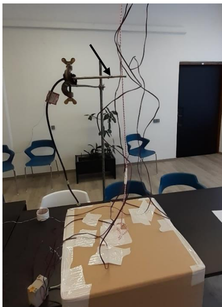
Slika 10. Lokacija anemometra iznad Modela 2
