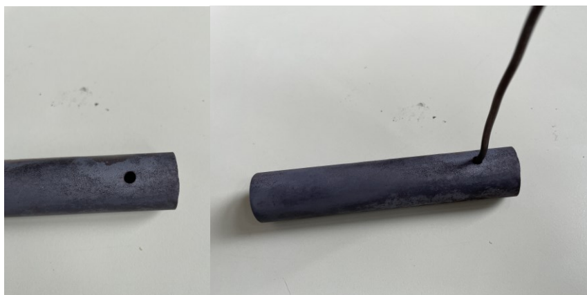
Slika 27. Položaj termoelementa u uzorku B
