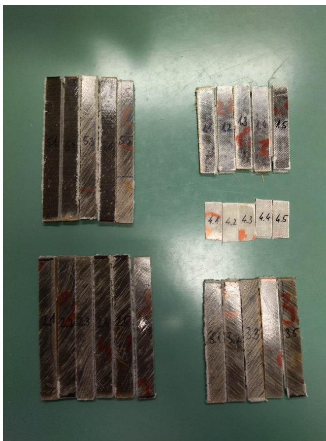
Slika 27. Prikaz ispitnih tijela za savojno ispitivanje
