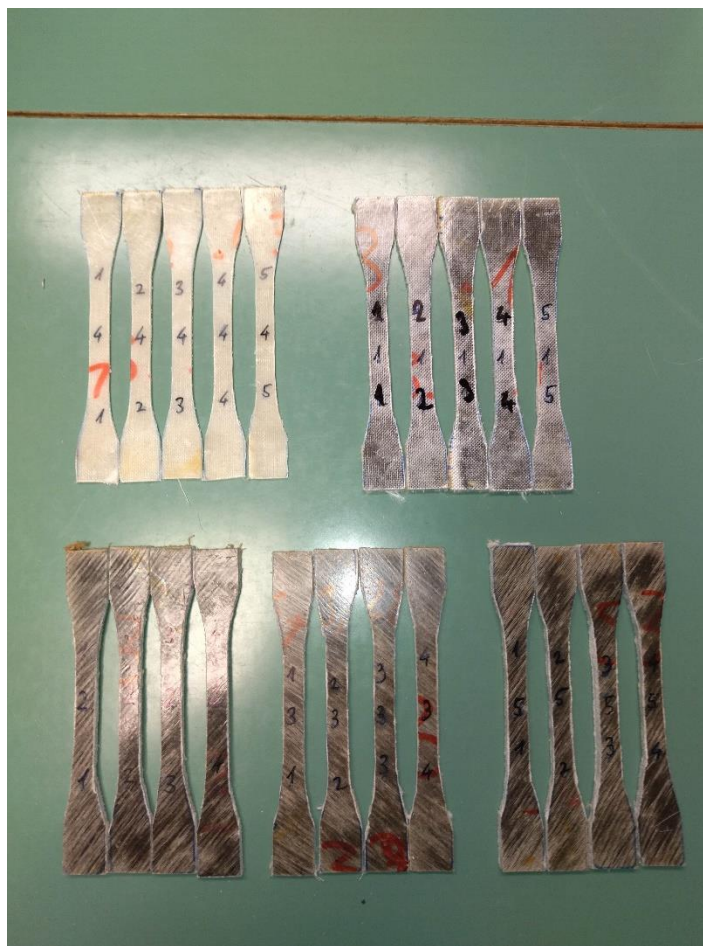
Slika 19. Ispitna tijela za rastezno ispitivanje
