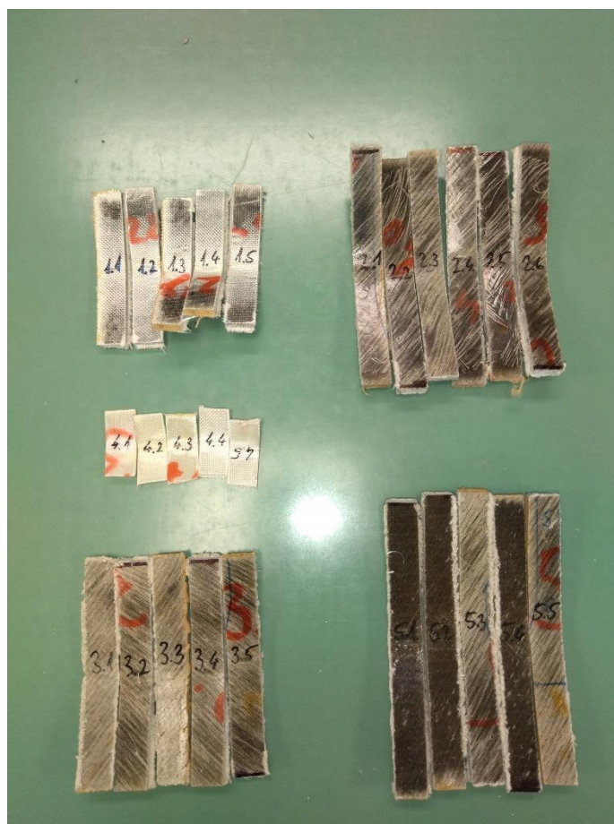
Slika 29. Prikaz ispitnih tijela nakon savojnog ispitivanja
