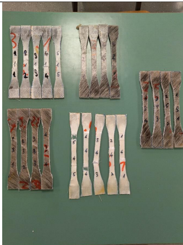
Slika 21. Prikaz ispitnih tijela nakon rasteznog ispitivanja
