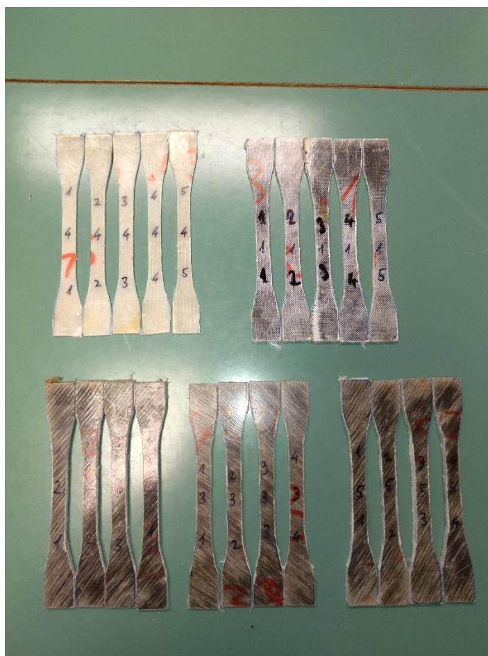
Slika 19. Ispitna tijela za rastezno ispitivanje
