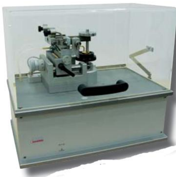
Slika 58: Standardni tribometar koji radi na principu pin-on-disc tvrtke CSM [22]
