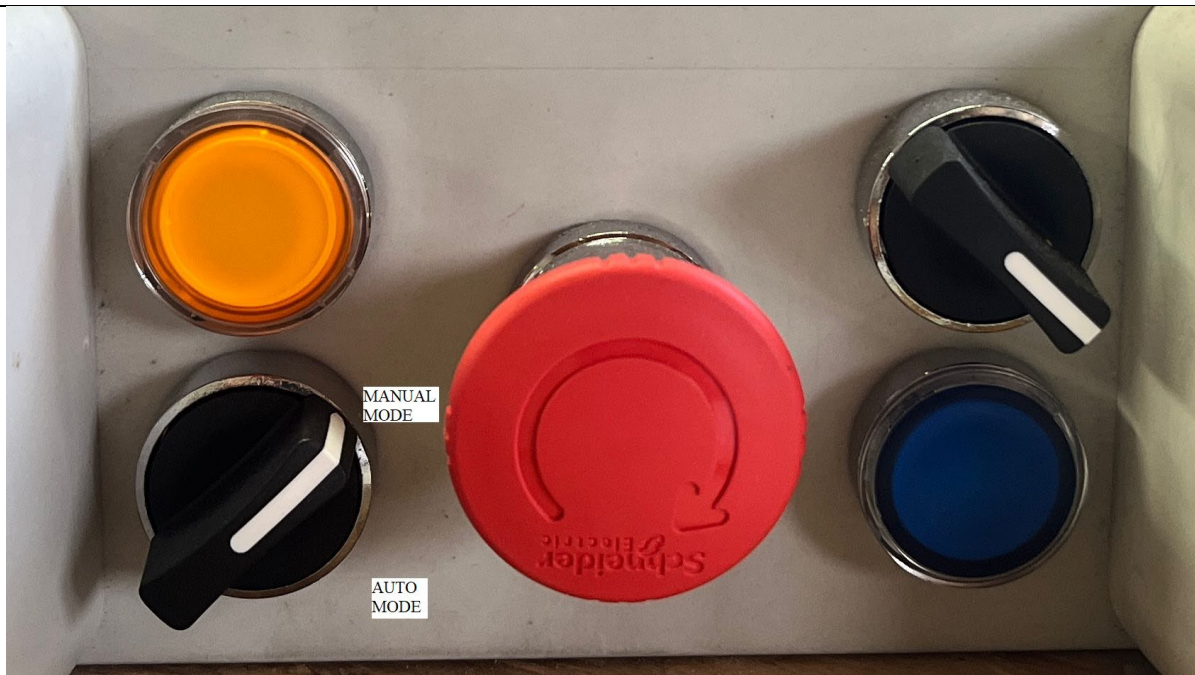
Slika 31. Odabir načina rada pomoću sklopke
