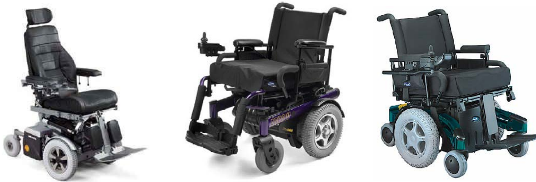
Slika 3 Invalidska kolica sa raznim položajem pogonskih kotača (s lijeva na desno): s prednjim položajem, sa stražnjim položajem, sa središnjim položajem
