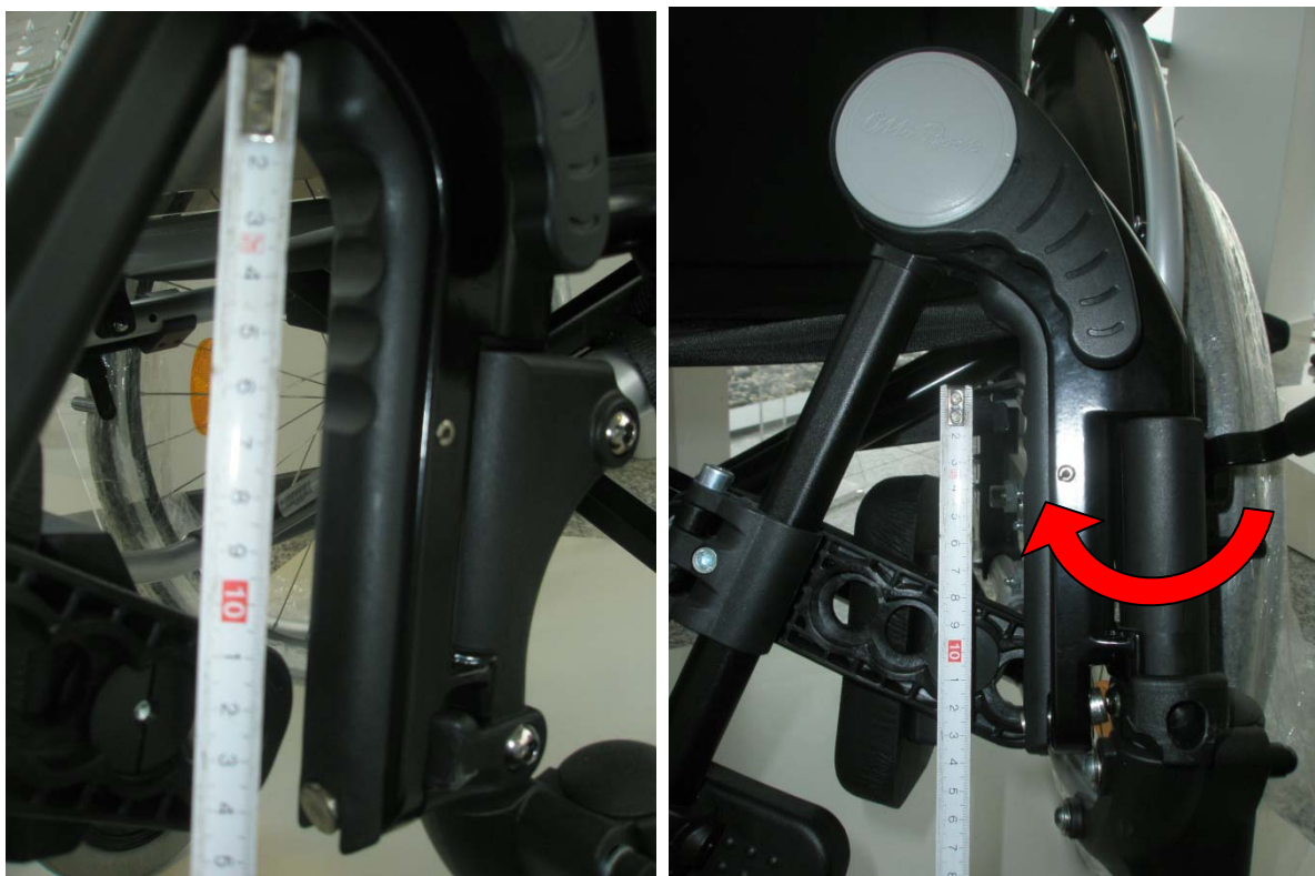
Slika 14 Rješenje koje kod modela 4 omogućuje jednostavno odmicanje ili skidanje odmorišta za noge
