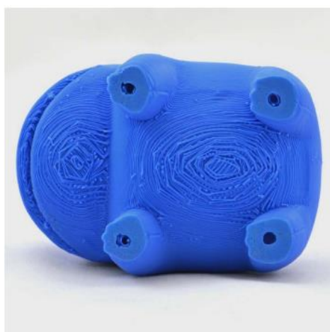
Slika 25. Oštećenja površine ispod potporne strukture [2]
