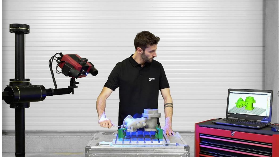
Slika 26. Postupak 3D skeniranja [36]
