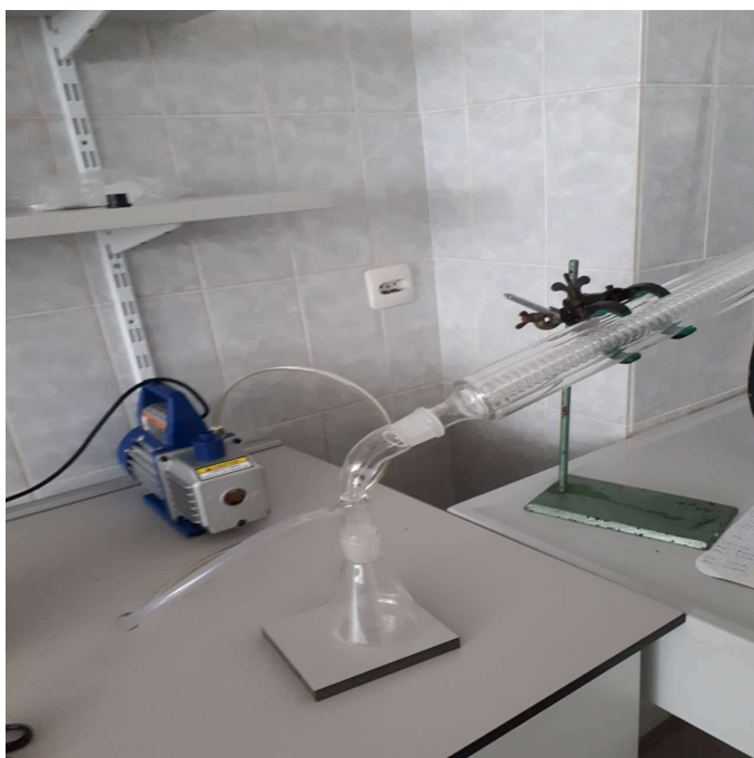
Slika 6: Vakuumska pumpa koja isisava zrak
