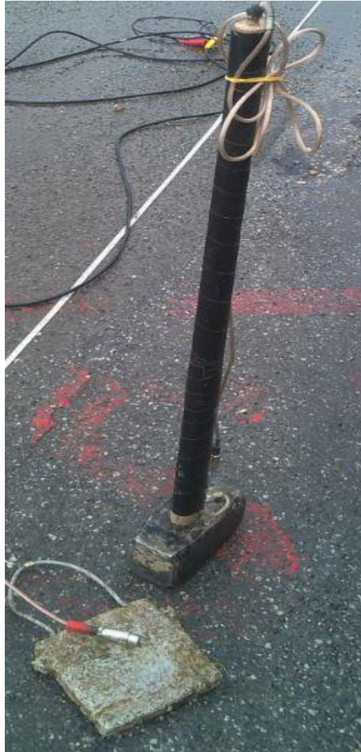
Slika 17. Čekić i metalna pločica kao izvor seizmičkog vala
