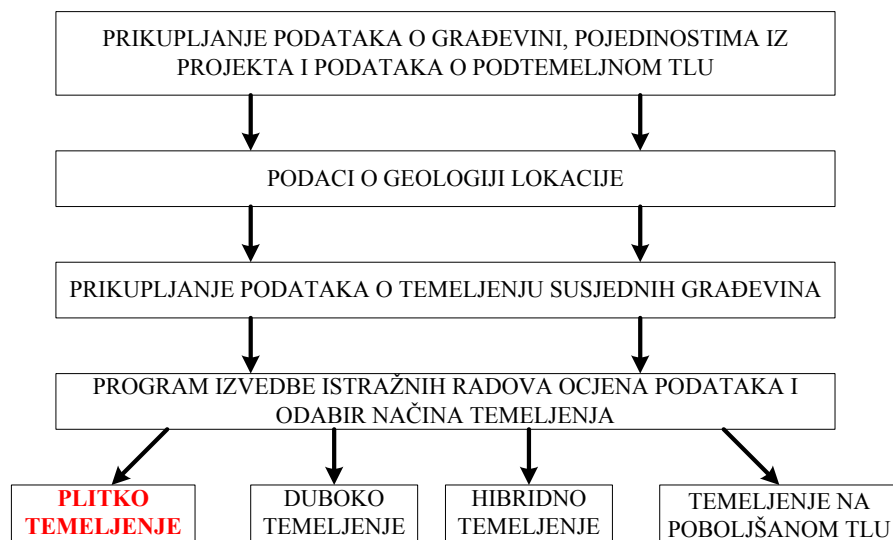
Slika 2.: Postupak projektiranja temeljenja
