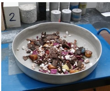
Slika 13. Dio uzorka za ispitivanje vlažnosti – prije sušenja
