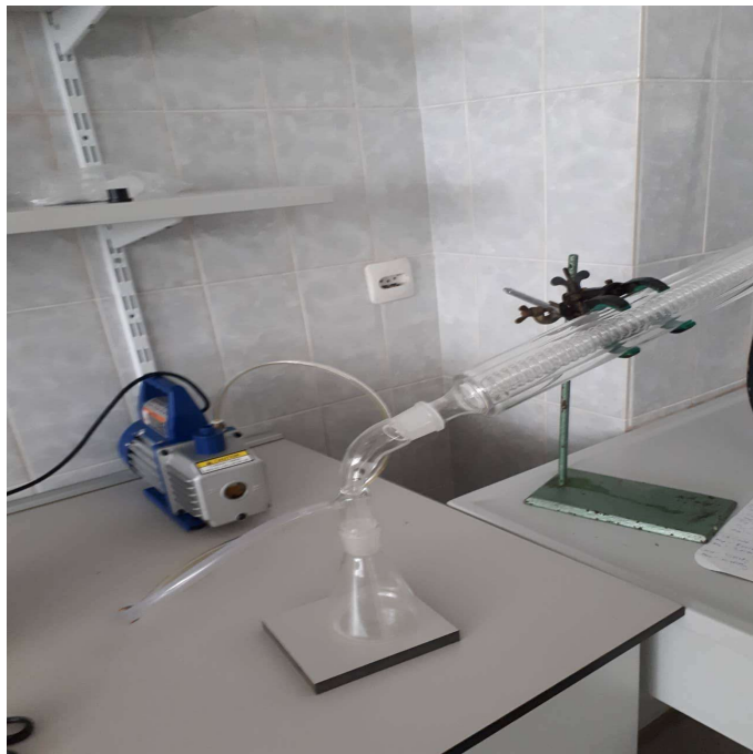
Slika 6: Vakuumska pumpa koja isisava zrak
