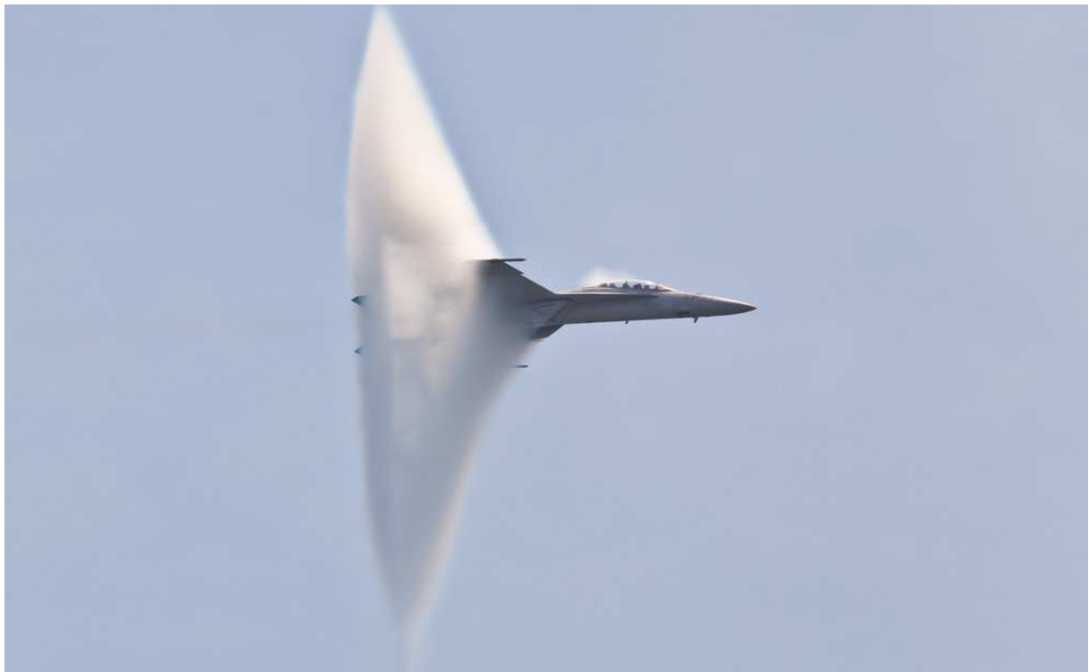
Slika 4. Probijanje zvučnog zida.
