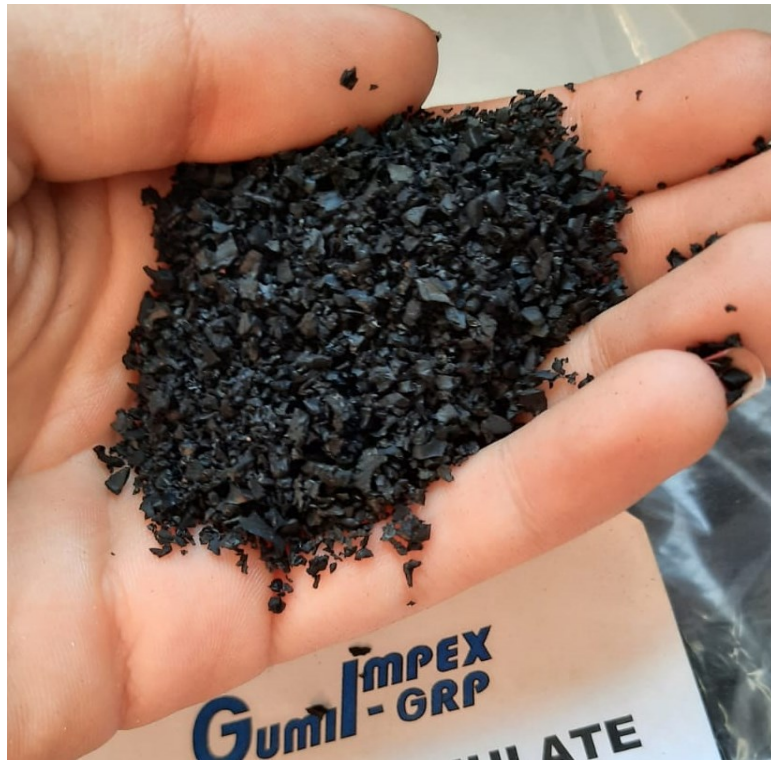
Slika 12. Gumeni granulat veličine 0,5 – 2,0 mm
