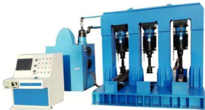
Slika 4.22. Uređaj za dinamičko i statičko ispitivanje tračnica [28]
