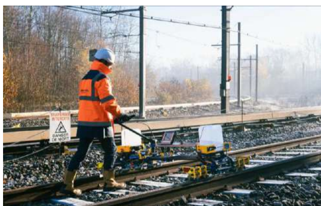
Slika 4.3. Kontrola geometrije kolosijeka ručno [10]
