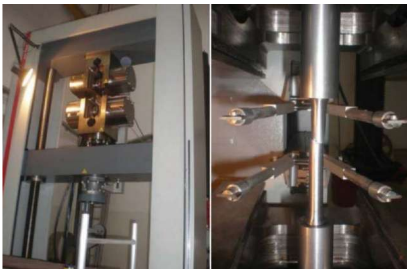
Slika 4.6. uređaj Zwick Roell Z600 za mjerenje vlačne čvrstoće [9]
