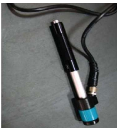
Slika 4.14. Nastavak Equotip 3 uređaja s kuglicom [7]
