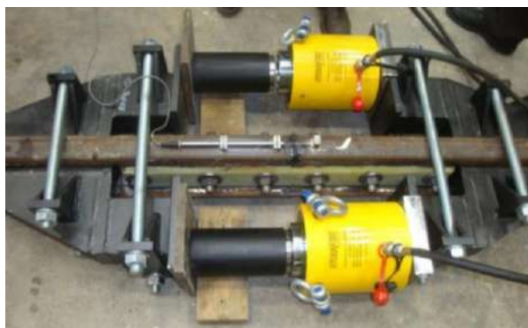
Slika 4.23. Vlačno ispitivanje izoliranih spojeva tračnica [29]
