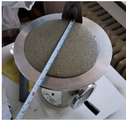
c) Određivanje konzistencije na stoliću za potresanje
