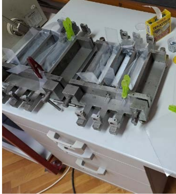
Slika 20: Priprema kalupa za mjerenje autogenog skupljanja
