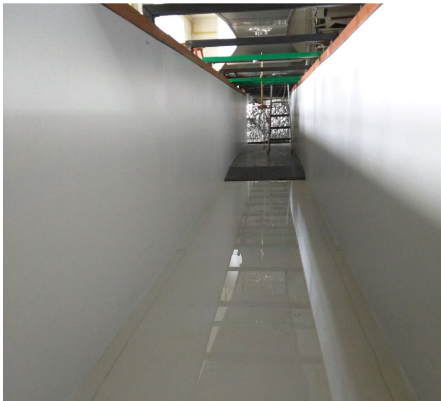
Slika 14 Valni kanal unutar Hidrotehničkog laboratorija Građevinskog fakulteta
