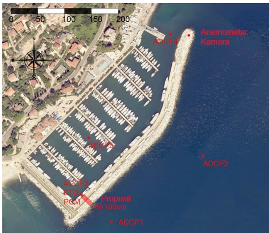
Slika 23 Tlocrtni prikaz ACI marine Opatija s pripadnim pozicijama instrumenata za mjerenje za zimsko razdoblje mjerenja (15.2.2017 – 31.3.2017) (instrumenti opisani u okviru poglavlja 4.2.2)
