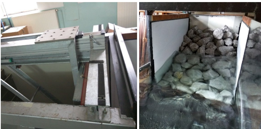
Slika 16 Valni generator tipa „piston“ na početku valnog kanala (lijevo) i disipacijska komora za smanjenje refleksije valne energije (desno)
