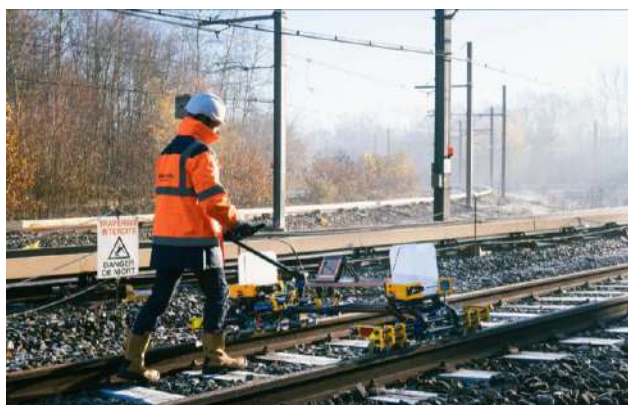
Slika 4.3. Kontrola geometrije kolosijeka ručno [10]
