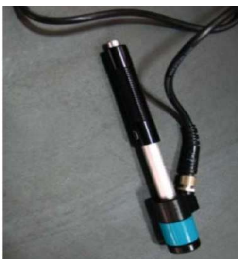
Slika 4.14. Nastavak Equotip 3 uređaja s kuglicom [7]
