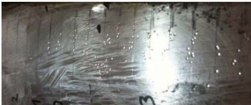
Slika 4.15. Otisci kuglice kod Brinellove metode [7]
