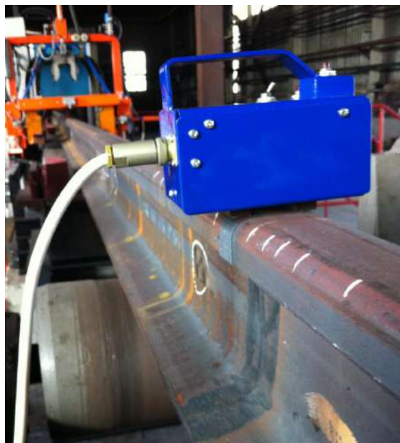
Slika 4.16. Defektoskop na bazi magnetskog toka [21]
