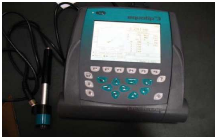
Slika 4.12. Uređaj za mjerenje tvrdoće prema Brinellu: Equotip 3 [7]
