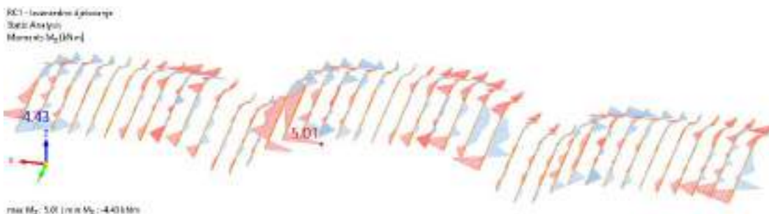
Slika 6.5 Dijagram momenata savijanja M_z [kNm]
