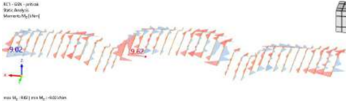
Slika 4.6 Dijagram momenata savijanja M_z [kNm]
