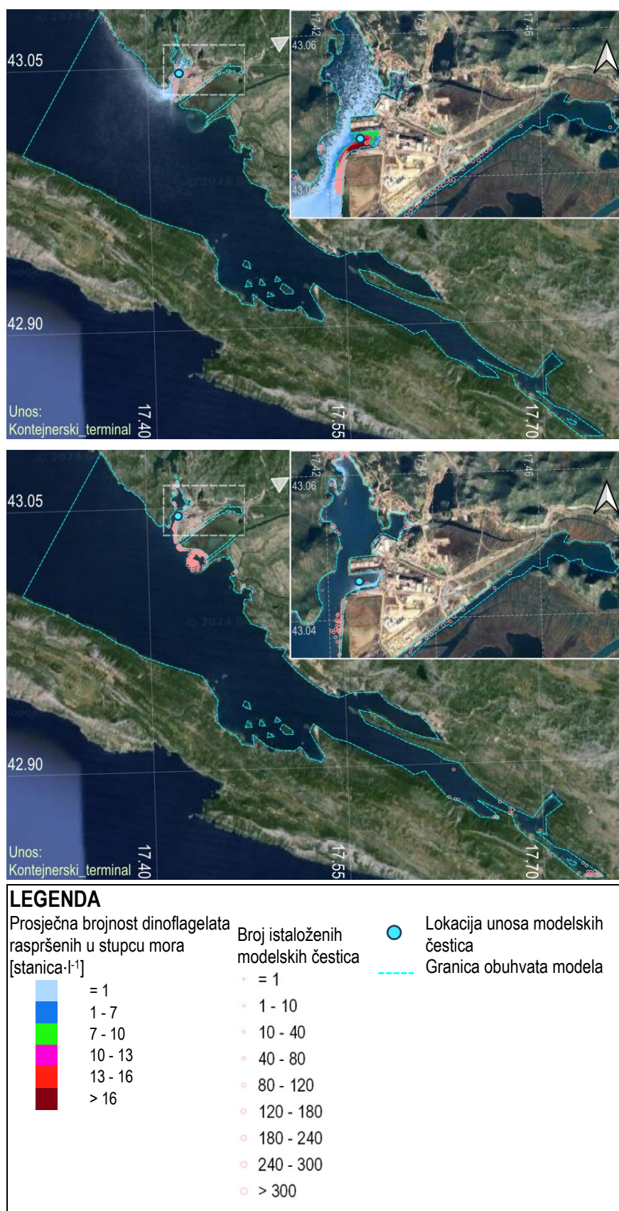
Slika 5-26 2D polja dinoflagelata raspršenih u stupcu mora i istaloženih na dnu za ZIMSKO (gore) i LJETNO (dolje) simulacijsko razdoblje za modelske čestice unesene u prostornu domenu šireg akvatorijalnog područja luke Ploče na lokaciji „Kontejnerski_terminal“ (podloga: Google satelit)
