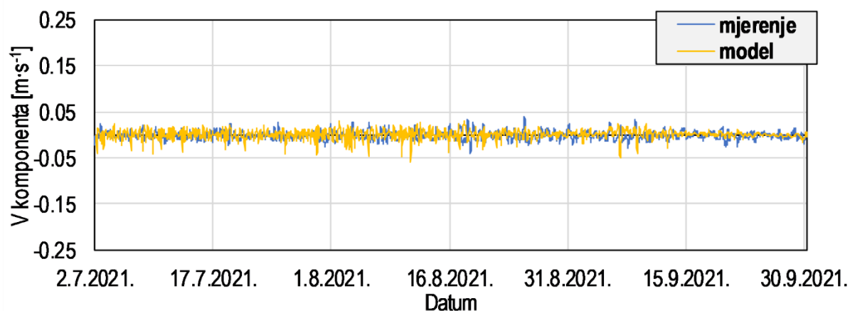
Slika 0-53 Usporedba U (gore) i V (dolje) komponenti brzine strujanja na dubini od -16 [m] za ljetno razdoblje na poziciji ADCP-RI1
