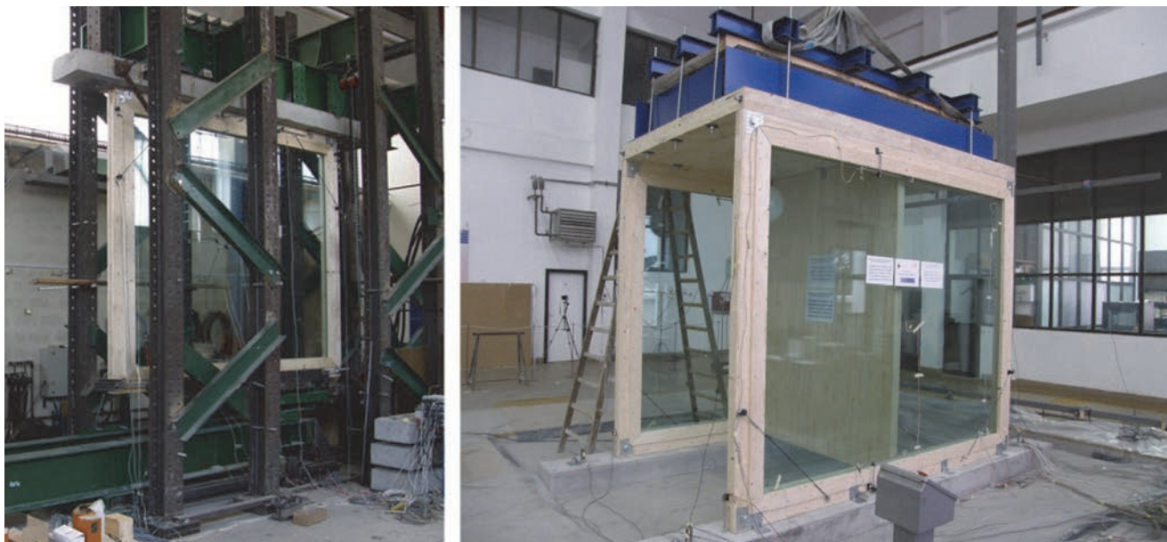
Slika 11. Kompozitni sustavi predstavljeni u radu Rajčić i Žarnić [7, 32-36]; kvazistatička ispitivanja i ispitivanja na potresnom stolu
