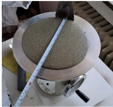
c) Određivanje konzistencije na stoliću za potresanje
