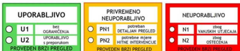
Slika 12: Naljepnice koje označavaju uporabljivost građevina nakon potresa (11)
